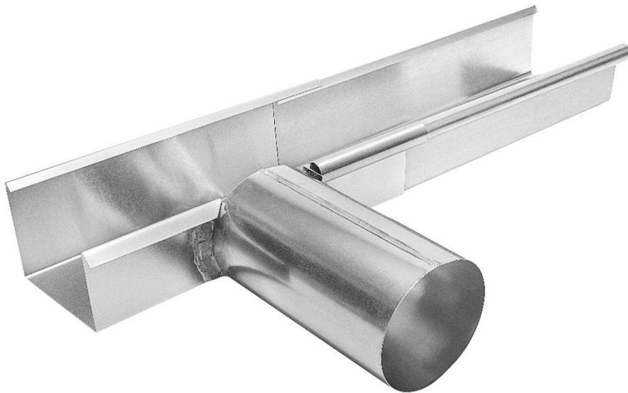
**Bildtext:** Der Auslaufstutzen für Gesims-Kastenrinnen wird mühelos zwischen zwei Gesimsrinnen eingelötet, die Überlappung der Rinnenabkantung durch mitgelieferten Wulstblenden verdeckt.
